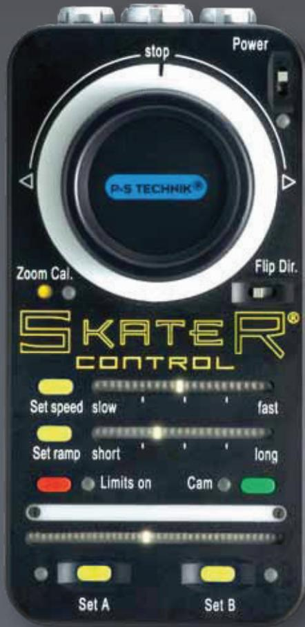
SKATER<sup>®</sup>控制装置为单轴遥控装置，可以对安装于SKATER<sup>®</sup>Mini上的摄影机的移动进行控制。也可以用来控制SKATER<sup>®</sup>转盘、SKATER<sup>®</sup>潜望镜上图像的旋转以及变焦控制。
